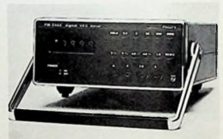
Hersteller: Philips Bezeichnung: PM 2522 Anzeige: Led, ± 1999 Bereiche: 26 (DCV, ACV, DCI, ACI, R) Auflösung: 0,1 mV; 0,1 Ω Meßfehler: ± 0,1%; ± 0,2% Stromversorgung: Netz, Akku Gewicht: 2 kg Preis: 950 DM
