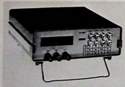
Fabrikat: Stolle Bezeichnung: DV 2000 Anzeige: \pm 1999 Bereiche: 12 (DCV, DCI, R) Auflösung: 1 mV Meßfehler: keine Herstellerangaben Stromversorgung: Netz Gewicht: keine Angaben Preis: keine Angaben
