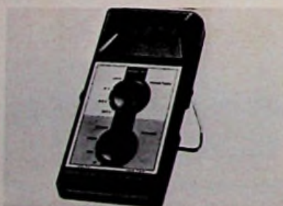
Hersteller: Data Technology Bezeichnung: Modell 21 Anzeige: Led, \pm 1999 Bereiche: 16 (DCV, ACV, R, C) Auflösung: 1 mV; 1 \Omega Meßfehler: \pm 0,15\% ; \pm 0,2\% Stromversorgung: Akku-Netz Gewicht: 340 g Preis: 399 DM
