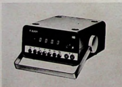
Hersteller: Hartmann & Braun Bezeichnung: T 2201 Anzeige: Röhren, ± 6144 Bereiche: 15 (DCV, ACV, R) Auflösung: 0,1 mV; 0,1 Ω Meßfehler: ± 0,1%; ± 0,5% Stromversorgung: Netz, Akku Gewicht: 2,5 kg Preis: 1190 DM
