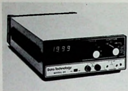
Hersteller: Data Technology Bezeichnung: Modell 20 Anzeige: \pm 1999 Bereiche: 16 (DCV, ACV, R, C) Auflösung: 1 mV; 1 \Omega Meßfehler: \pm 0,1\% ; \pm 0,15\% Stromversorgung: Netz Gewicht: 1050 g Preis: 890 DM
