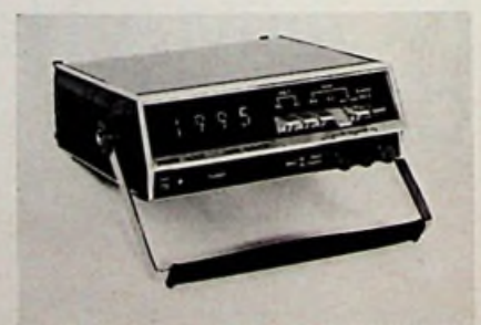
Hersteller: Philips Bezeichnung: PM 2423 Anzeige: Röhren, ± 1999 Bereiche: 15 (DCV, ACV, R) Auflösung: 1 mV; 0,1 Ω Meßfehler: ± 0,1%; ± 0,5% Stromversorgung: Netz Gewicht: 2 kg Preis: 990 DM
