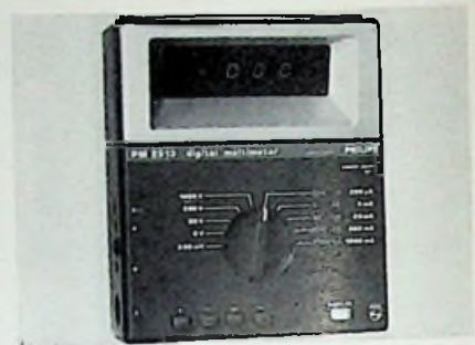
Hersteller: Philips Bezeichnung: PM 2513 Anzeige: Led, ± 1999 Bereiche: 26 (DCV, ACV, DCI, ACI, R, T) Auflösung: 0,1 mV; 0,1 Ω Meßfehler: ± 0,3%; ± 1,5% Stromversorgung: Batt., Akku, Netz Gewicht: 1 kg Preis: 650 DM
